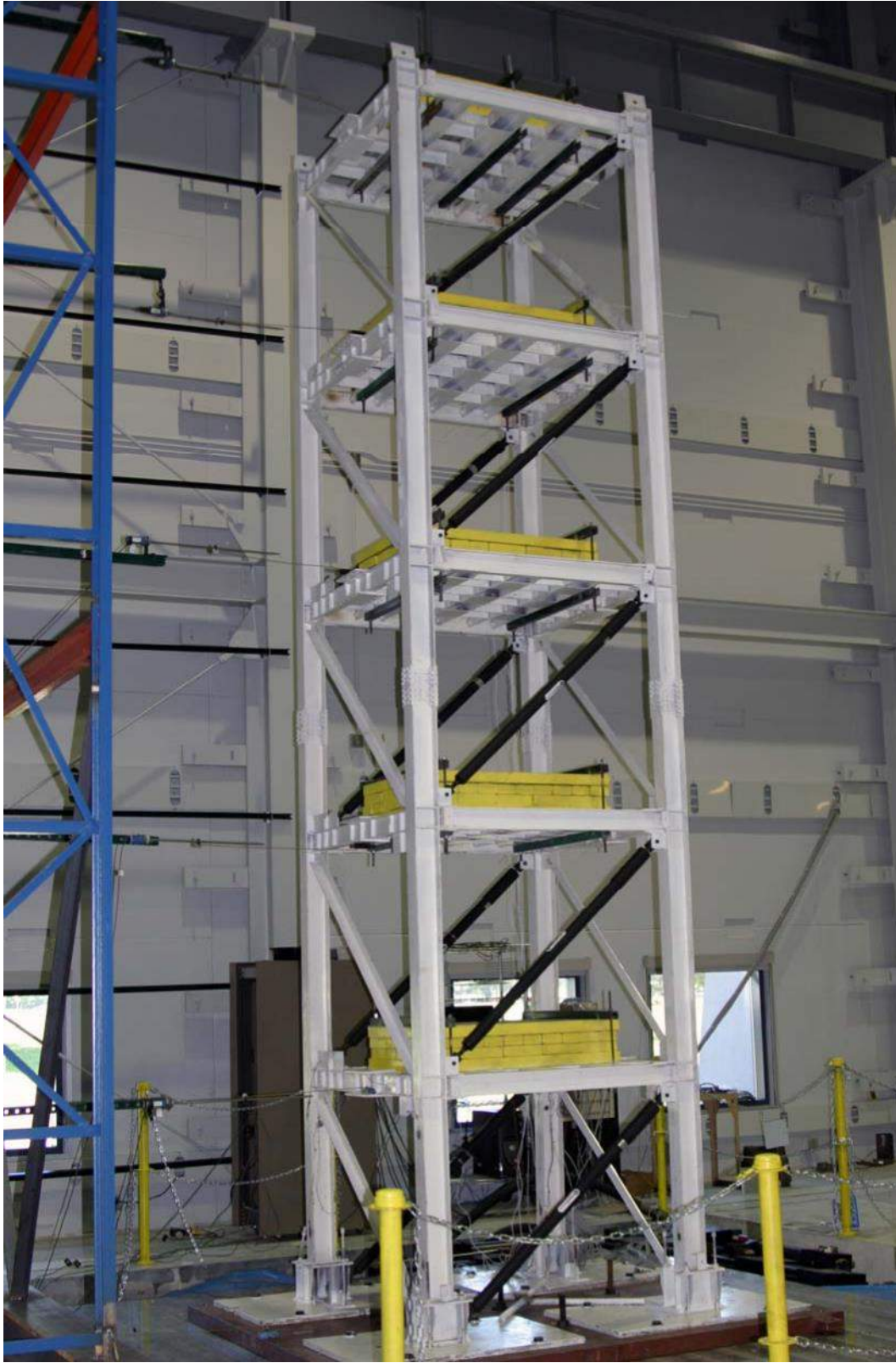
Figura 1: Fotografía del modelo estructural de cinco pisos con sistema de amortiguación en uno de los nuevos simuladores sísmicos en la Universidad de Búfalo.
